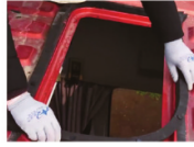
2. Üst camın çevresine izolasyonu yapıştırın
